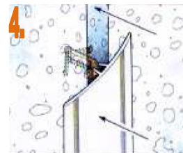
Couvre joint en place
